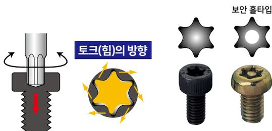
별(헥스로브) 나사/공구는 기존의 십자/일자 및 육각 방식과 달리 삽입구가 6개의 별형(HEXLOBE)으로 되어 있습니다. 이는 나사에 닿는 면적이 넓혀 힘을 나사전체에 분산시키기 위함이며, 결과적으로 토크효율이 향상되어 적은 힘으로 큰 토크를 낼 수 있게 해줍니다. 또한 캠아웃 (Cam-out, 헛도는) 상태에서 나사가 뭉개지는 것을 방지합니다.
